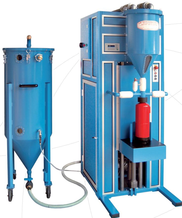
Die Anlage arbeitet in den von der EN3-Norm festgeschriebenen Fülltoleranzen. Die Einstellung der Werte des Füllgewichts erfolgt am Waagen-Display, die Einstellung der modellspezifischen Füllparameter erfolgt über das Textdisplay. Die Höheneinstellung der Wiegeplattform wird mittels Spindelantrieb erreicht.
