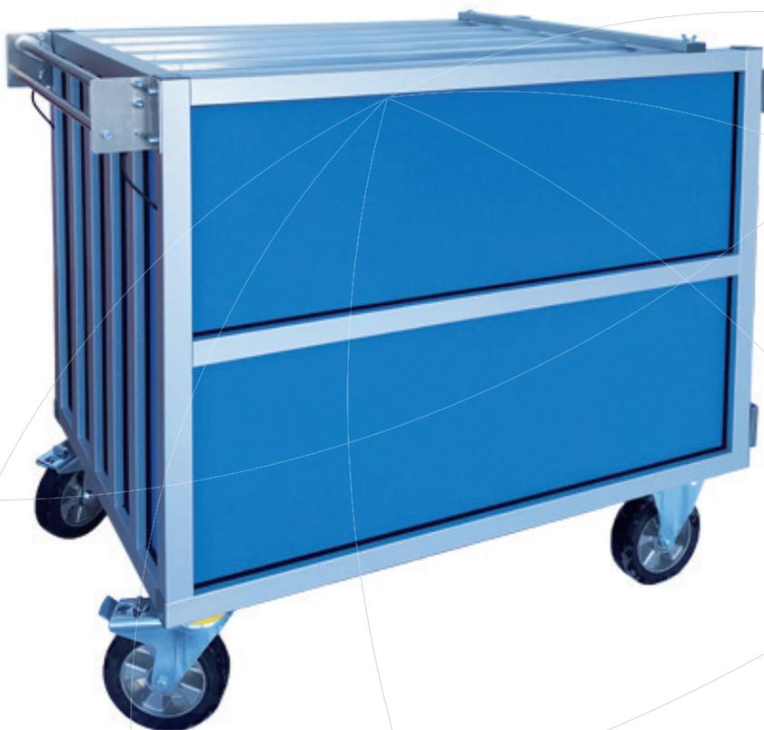
Er ist ausgestattet mit zwei Lenk/ Brems- und zwei Bockrädern. Die Räder haben durch ihre Aluminium-Felgen mit Vollgummibereifung kaum Rollwiderstand und garantieren trotz des Gewichts eine leichte Beweglichkeit des Wagens auch im unwegsamen Gelände. Die Einzelradbelastung liegt bei 400 kg.
