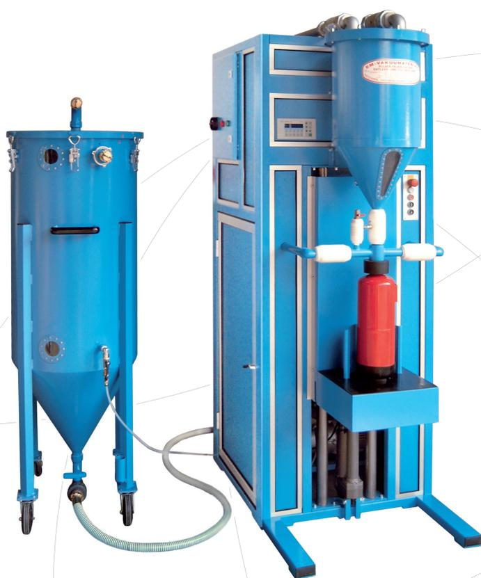
Cette station fonctionne dans le respect des tolérances de remplissage prescrites par la norme EN3. La valeur du poids à remplir se règle au niveau de l'écran de la balance, les paramètres de remplissage spécifiques à chaque modèle devant être renseignés au niveau de l'écran de texte. La plateforme de pesage se règle en hauteur au moyen d'un entraînement à broche.
