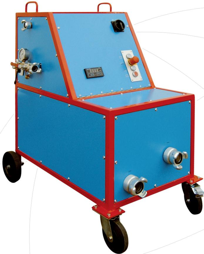
Le WHP/WT/T est équipé d'un réservoir d'eau, d'une pompe HP, d'un dispositif de séchage de tuyaux et d'un manomètre à contact réglable. Le manoccontact arrête automatiquement la pompe dès que la pression présélectionnée est atteinte.
