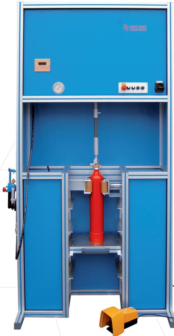
Convient pour les bouteilles de diamètre compris entre 80 et 210 mm. Pour les autres diamètres, il existe des accessoires spécifiques qu'il faut commander en fonction du cas de figure. La puissance élevée du vérin pneumatique de 125 mm de diamètre permet de desserrer les raccords vissés les plus difficiles.
