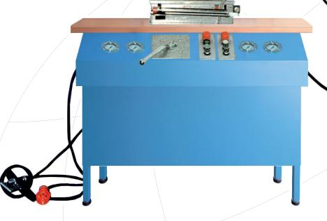
Le HF 504 R est équipé d'une pompe d'alimentation puissante, ce qui garantit un remplissage rapide des grandes bouteilles à l'aide d'une balance au sol séparée.
