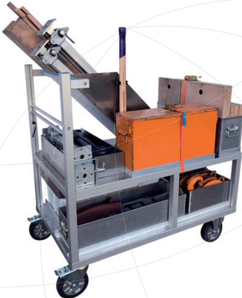
Grâce aux jantes en aluminium, les roues avec bandage en caoutchouc plein n'ont pratiquement pas de résistance au roulement et garantissent une mobilité aisée du véhicule malgré son poids, même sur un sol difficile. La charge de roue individuelle est de 400 kg.
